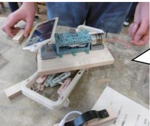
**「ソーラー乾燥機」** 日光のエネルギーでモーターを回し乾燥させる。
