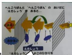
偏光板と偏光板の間に位相差板があると光の向きを変えるのでちがう色の光がでできます。
