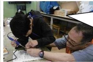
電池ボックスのリード線をカップのふちの穴に通して基板と半田付けするよ。
